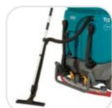
**La lance d'aspiration** permet un nettoyage rapide des déversements inaccessibles pour la machine.
